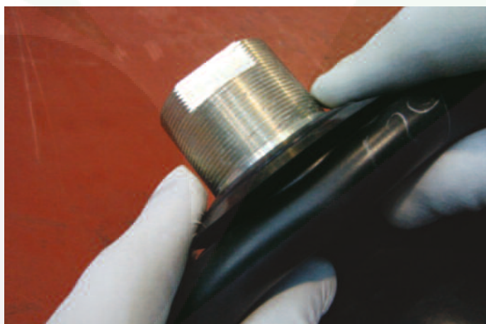
- Вдавите газовый клапан и прорезиненную прокладку к баллону 3.7v
