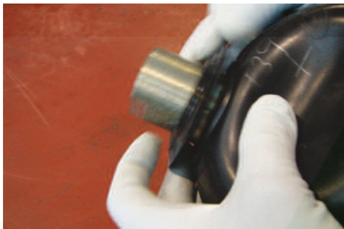
- Наденьте прорезиненную прокладку до конца клапана 3.7u
