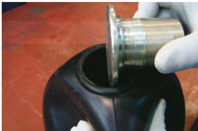
- Вставьте корпус газового клапана в горловину баллона и надавите 3.7r
