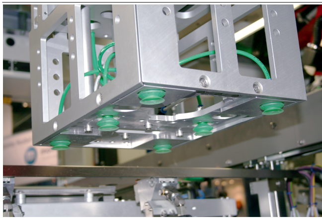
Сильфонные присоски SPB1, используемые для перемещения картона
