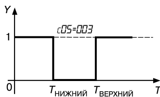
Рис. 3.17. Компаратор срабатывает вне установленных пределов
