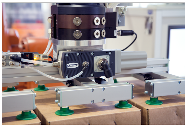
Централизованное генерирование вакуума с помощью компактных эжекторов SBPL
